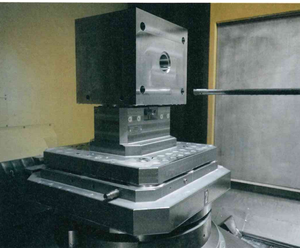
1 Die großen Haltekräfte und die Wiederholgenauigkeit der AMF-Nullpunktspannmodule sind speziell für die Präzision der Tieflochbohrungen extrem wichtig © AMF
