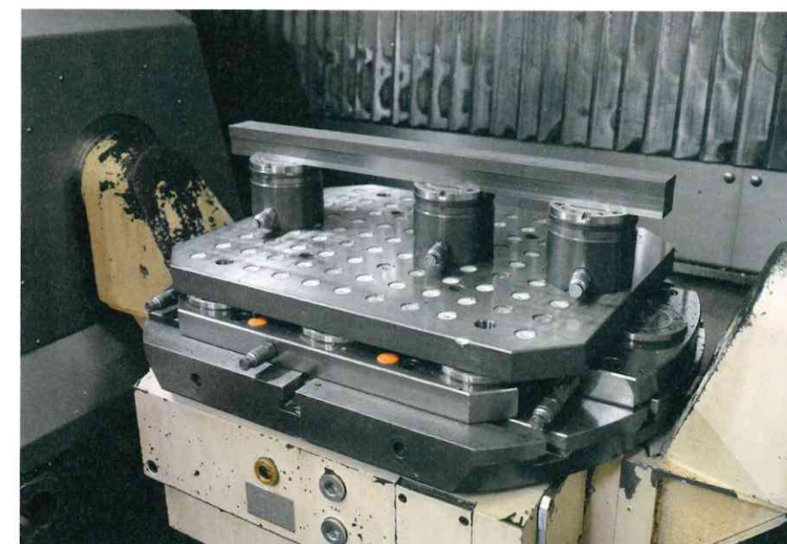
3 Obwohl AMF-Nullpunktspannmodule große Kräfte aufbringen, bauen sie nicht sehr hoch © AMF
