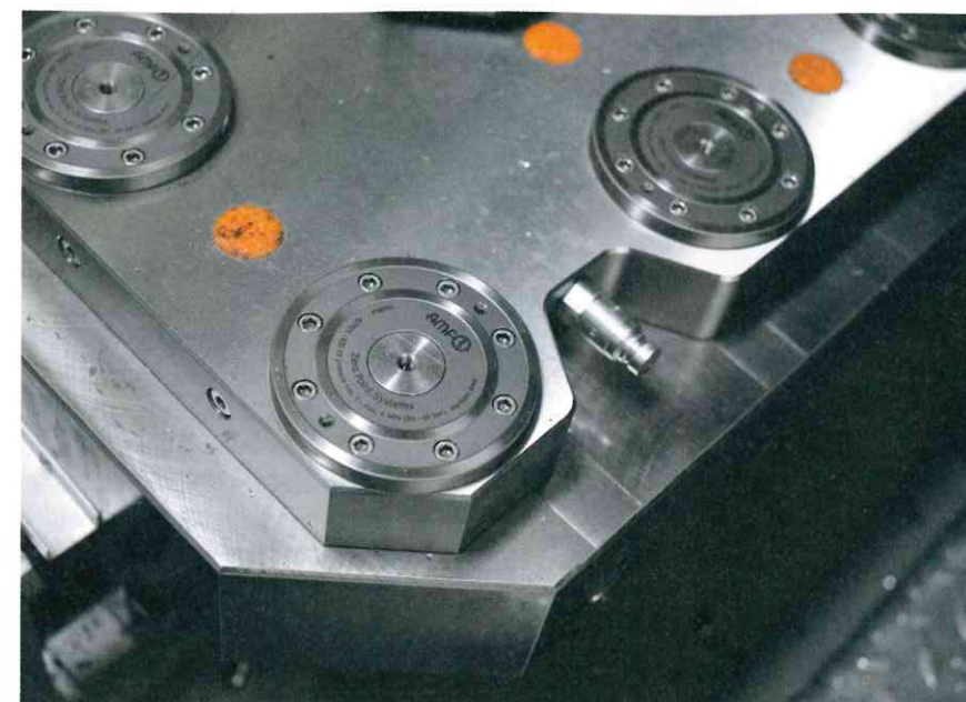
2 Zu kurzen Rüstzeiten leistet die umfangreiche Werkstückspanntechnik von AMF rund um starke und flache Nullpunktspannmodule einen wichtigen Beitrag © AMF
